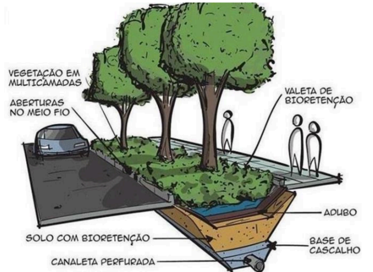
Figura 3. Estrutura do sistema de biovaleta.
