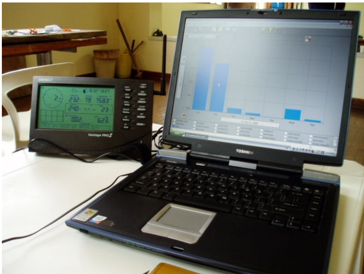
Figura 09 - O console, receptor telemétrico dos dados, foi instalado na sede do Instituto Florestal, direção do Núcleo Cabuçu. Na foto, dados sendo baixados e armazenados no note book , também adquirido pelo Projeto.
