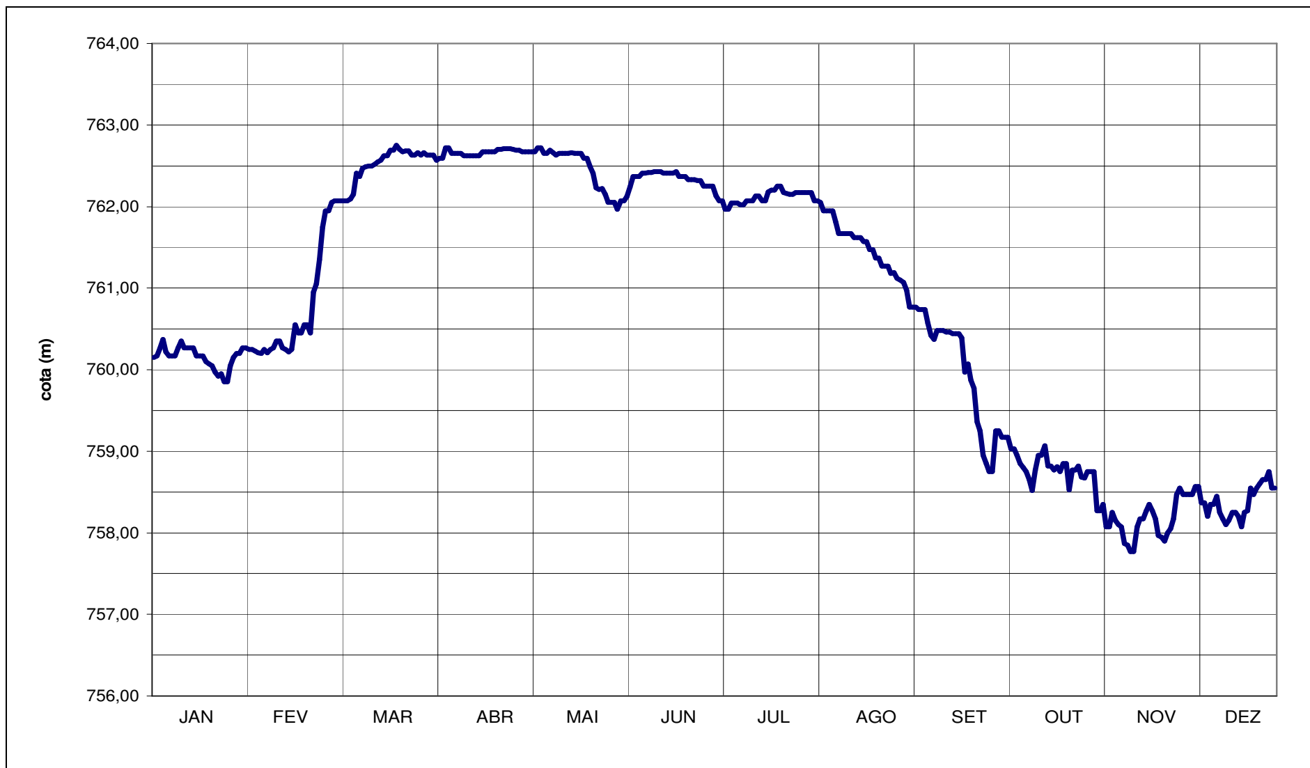
Figura 23 – Variação do nível do reservatório durante o ano de 2004 (cota do nível da soleira do extravasor: 763,5m)
