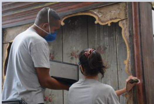
Realização de exames de área com muitas dejeções, com microscópio digital acoplado a computador
